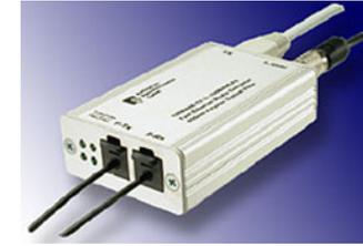
Medienkonverter setzen Signale von einem Transportmedium auf ein anderes um, z.B. von Cu-Kabel auf Lichtwellenleiter.
